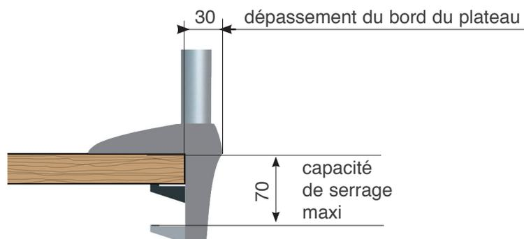
Pièce mécanique réalisée en acier (épaisseur 5 mm).
