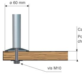
Capacité de serrage: 40 mm Pour une capacité supérieure, changer la longueur de la vis.
